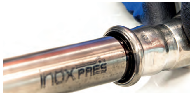
Afbeelding 33 – Voorbeeld van een onjuiste markering
