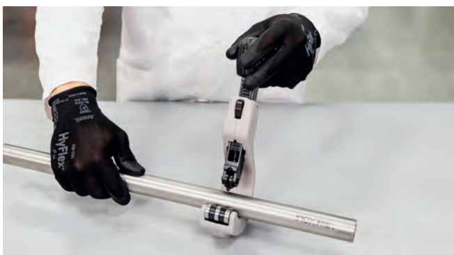
Afbeelding 26 – De buis op lengte snijden
